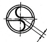
Querschnittenlänge 10% vom Bohrer - Ø
