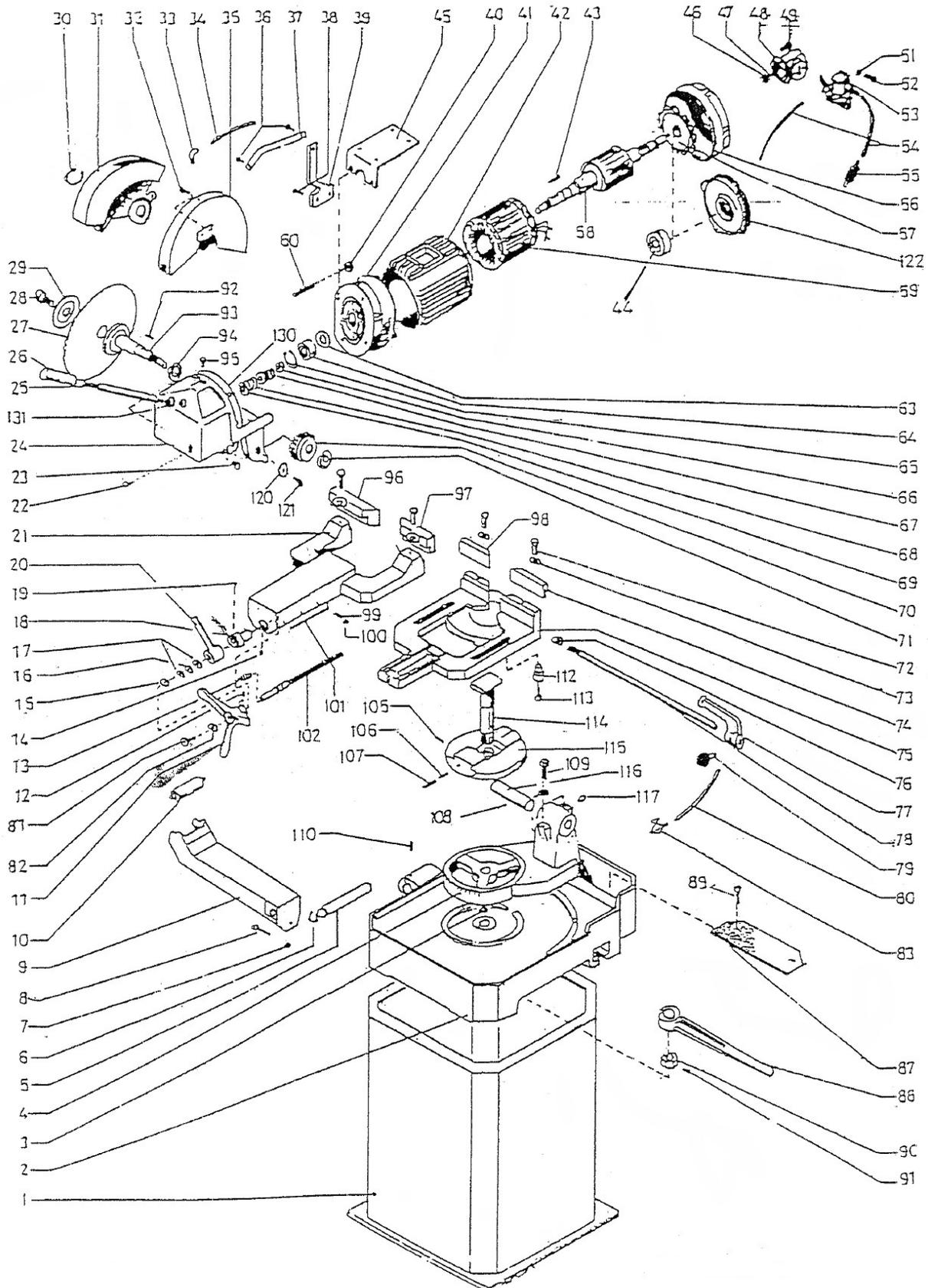
Abb. / Fig. 9: Ersatzteilzeichnung 1 - MKS 315 N / Spare parts drawing 1 - MKS 315 N
