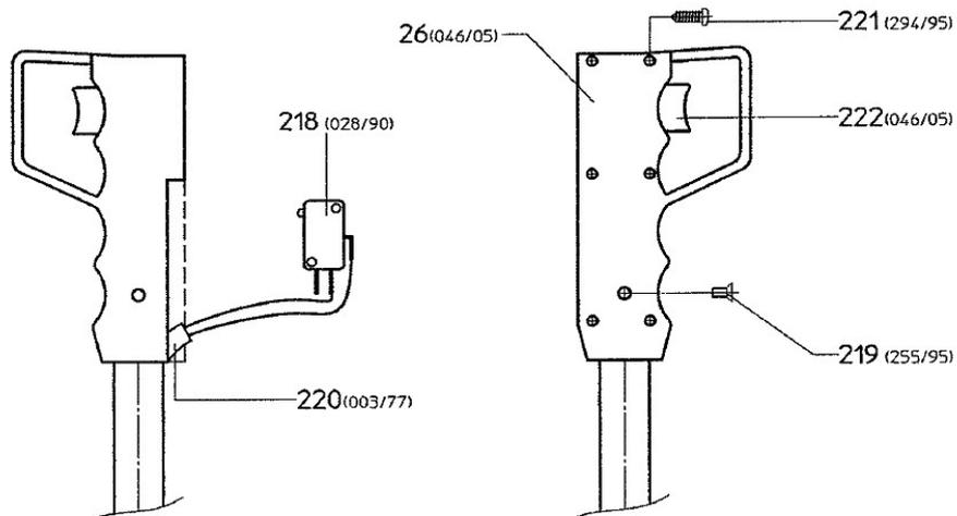
Abb. / Fig. 12: Ersatzteilzeichnung 4 - MKS 315 N / Spare parts drawing 4 - MKS 315 N
