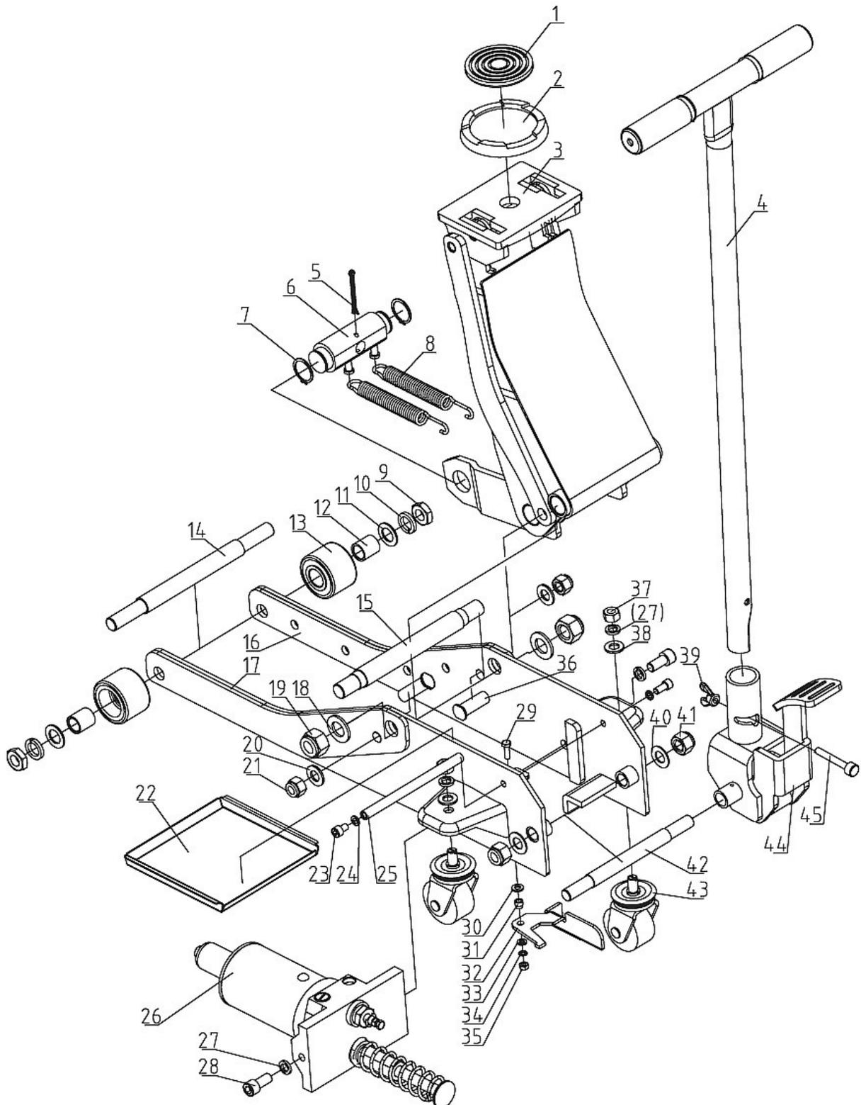
Abb./Fig. 1: Ersatzteilzeichnung 1 - SRWH 2000 LF DS / Spare parts drawing 1 - SRWH 2000 LF DS
