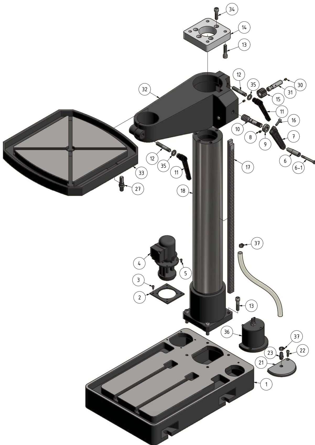
Abb.9-12: Säule und Bohrtisch - Column and drilling table
