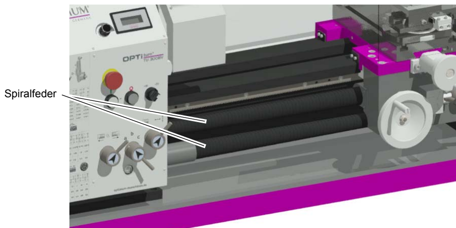
Abb. 1-4: Leit- und Zugspindel mit Schutzabdeckung
