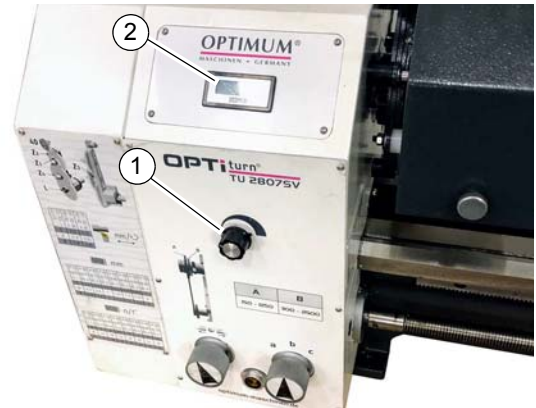
DrehzahlEinstellung (1) und Drehzahlanzeige (2)
