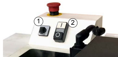
Schalter Drehrichtung (1) Schalter Ein / Aus (2)
